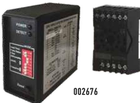
Der elektromagnetische Detektor LD212 kann eine oder zwei Magnetschleifen verwalten und ein Ausgangssignal an den Durchgang eines Metallkörpers mit diskreten Abmessungen (Auto, Motorrad usw.) auf den Schleifen liefern. Es kann in beide Fahrrichtungen arbeiten oder Sie können auswählen, in eine einzige Richtung zu arbeiten.
